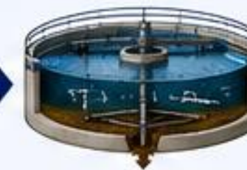
Vorklärung (nach Rechenanlage und Fett- und Sandfang)
