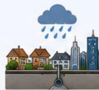
Mischwasser aus dem Kanalnetz
